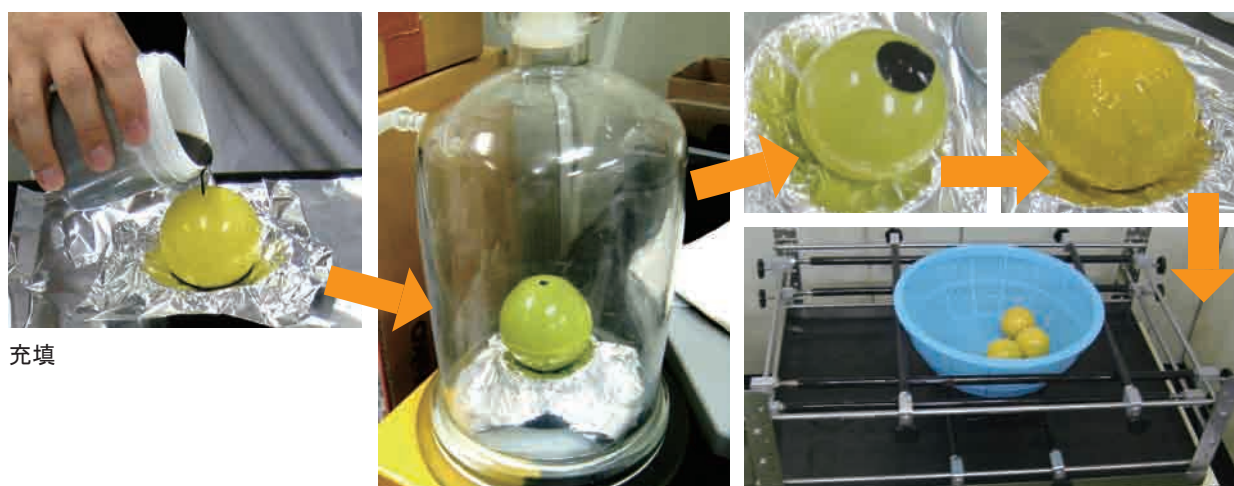
第61図 試験体の作製方法
