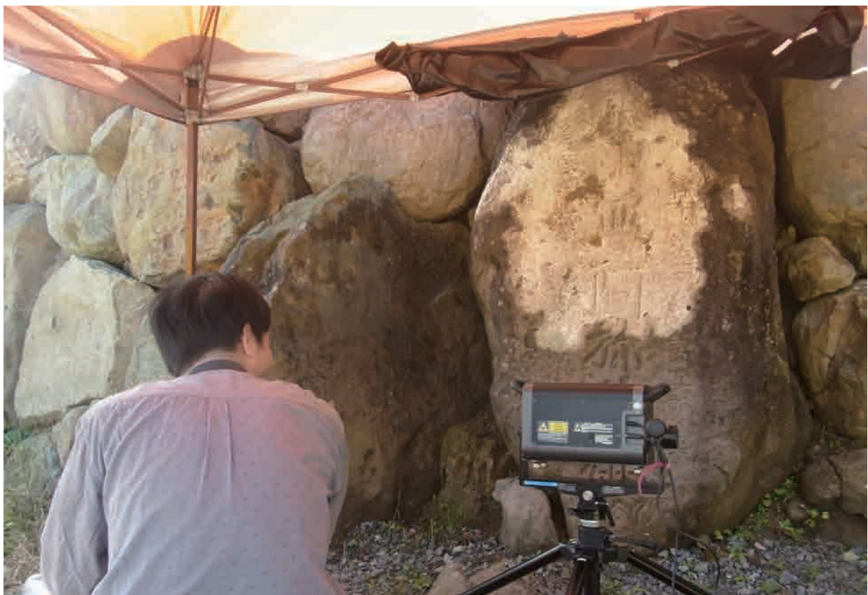
第90図 固定型レーザー計測の様子
