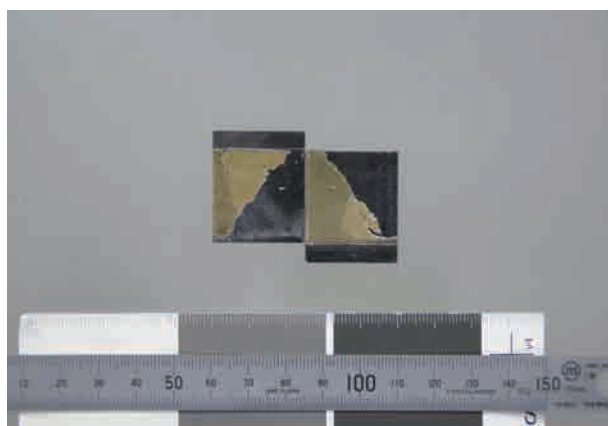
第73図 圧縮せん断試験後の試験体
