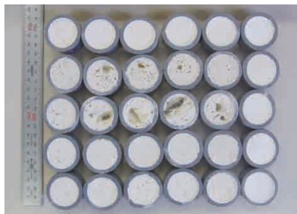
第50図 漆喰の試験体(促進耐候性試験後)
