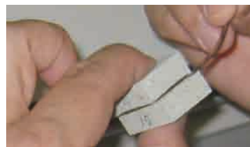
はみ出した樹脂の除去
