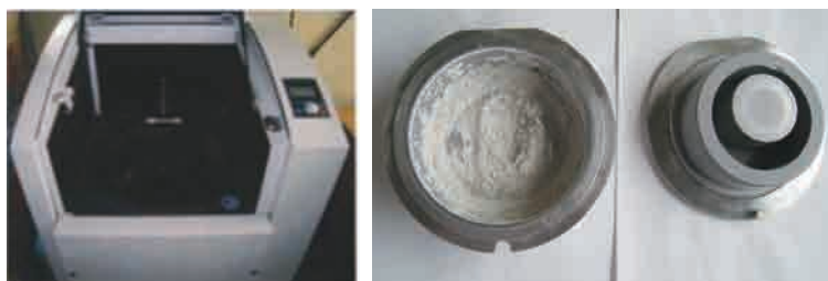
粉碎機 粉碎容器セット前 粉碎容器中の粉碎粉 第52図 標準砂の粒度調整
