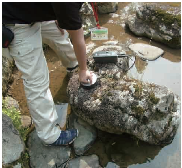
第27図 含水率の計測状況
